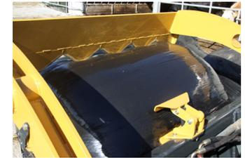
3. Transportez la balle jusqu'à l'endroit où vous voulez la couper et utilisez le levier de commande hydraulique pour fermer la pince coupante Bale Shear afin qu'elle perce le ruban plastique et qu'elle tranche la balle jusqu'au centre.
