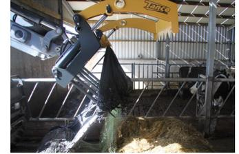
5. Continuez à lever le chargeur pour dérouler le ruban plastique, qui est encore retenu par les mâchoires de la pince, et le séparer de la balle.
