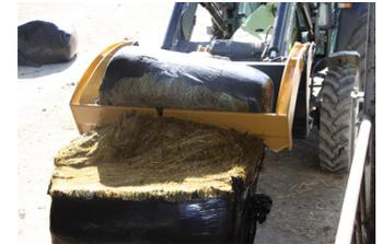
4. Utilisez les leviers de commande pour qu'ils ouvrent presque entièrement la pince coupante Bale Shear, tout en levant le chargeur pour répandre efficacement les deux moitiés de la balle, soit sur le passage d'alimentation, soit sur la remorque d'affouragement.
